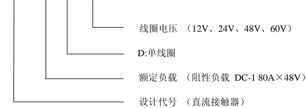
例: DYZ1-80D/48; 表示: 焊接式常开接触器, DC-1 负载下额定电流为 80A, 线圈电压 DC48V。
